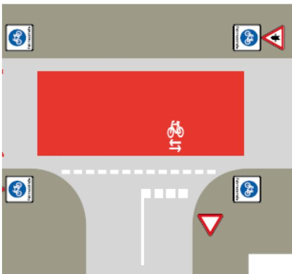
**Bild 3-3: Ausgestaltung eines bevorrechtigten Knotenpunkts (Quelle: AGFS-Leitfaden, D.75)**
